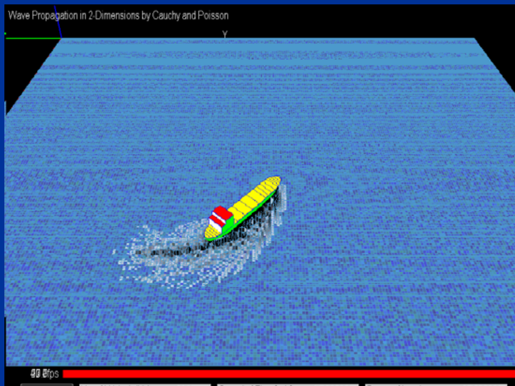
自由旋回する船がつくる波のシミュレーション
