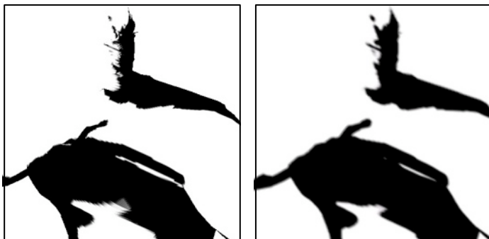
図13. シャドウマスクテクスチャ。左がフィルタ適用前、右が適用後。
