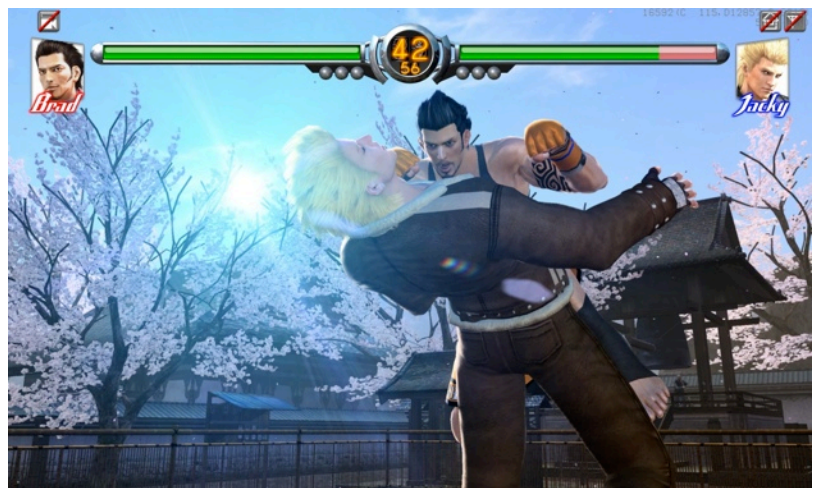
図10. 太陽フレア描画。太陽が視界に入った時はほぼ全画面にフレアのテクスチャを張るので、トーンマップ処理に組み込んでパフォーマンス改善を図った。
